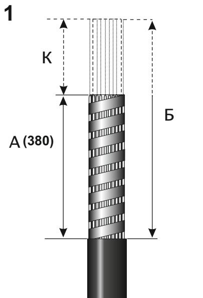
Удалить наружный покров кабеля на длине **A (380мм)**.
