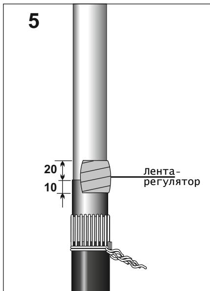
Выполнить подмотку одной лентой-регулятора длиной **200 мм** участка кабеля с заходом **10мм** на проводящий слой и **20мм** на изоляцию жилы. Подмотку производить вытягивая ленту до половины исходной ширины с **30%** перекрытием слоев, постепенно удаляя упаковочную бумагу.
