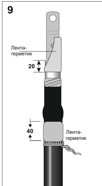
Выполнить подмотку лентой регулятором длиной **200** мм, участок разделки кабеля с заходом 10мм на трубку ТРН и 20мм на изоляцию жилы кабеля. Подмотку производить вытягивая ленту до половины исходной ширины с 30% перекрытием слоев, постепенно удаляя упаковочную бумагу.
