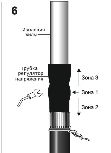
Надеть трубку регулятор напряжения (TRH) **200 мм** на разделку кабеля в плотную к проволокам экрана. Усадить трубку, начиная в области центра намотки ленты-регулятора - зона 1, затем продолжить в сторону основания разделки кабеля - зона 2 и завершить усадку на изоляции жилы - зона 3.
