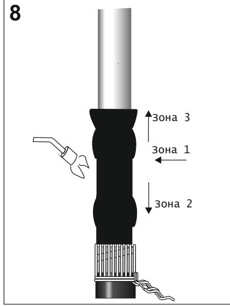
Надеть трубку регулятор напряжения большей длины (ТРН-35) **300 мм** на жилу кабеля вплотную к проволокам экрана. Усадить трубку, начиная в области центра намотки ленты-регулятора
