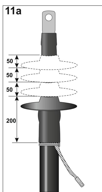
Для муфт наружной установки в целях увеличения длины пути тока утечки внешней изоляции (если это необходимо) установить термоусаживаемый изолятор на манжете изоляции оболочки. Первым необходимо устанавливать нижний изолятор, как показано на рисунке. Усадить изолятор и последующие за ним. Монтаж муфты наружной установки закончен.
