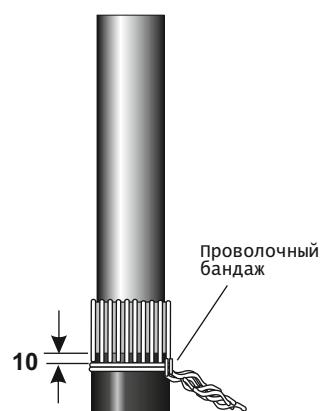
Отогнуть и равномерно разложить проволоки экрана на наружном покрове кабеля, избегая при этом перехлеста проволок. Закрепить проволоки экрана кабеля 3-4 витками медной проволоки в **10мм** от нижнего края ленты герметика на наружном покрове кабеля. Удалить ленты проводящей бумаги с проводящего слоя. Сплести проволоки экрана, образуя провод заземления.
