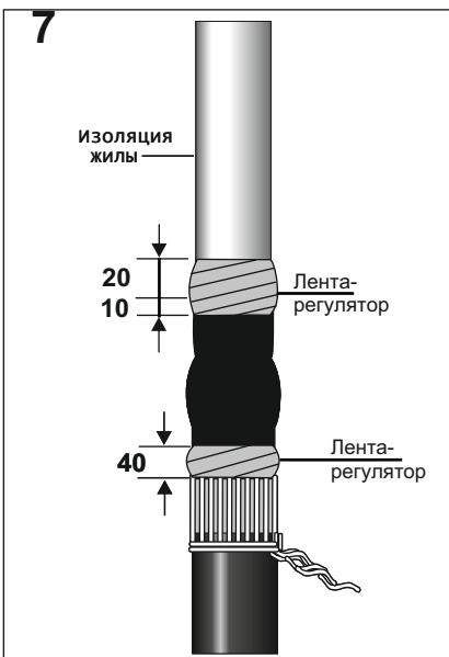
Выполнить подмотку лентой регулятором длиной **0,2м**, участок разделки кабеля с заходом **10мм** на трубку ТРН-35 и **20мм** на изоляцию жилы кабеля.
