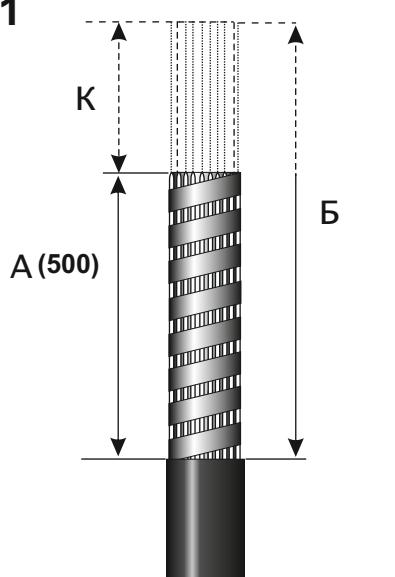
Удалить наружный покров кабеля на длине **A (500мм)**.
