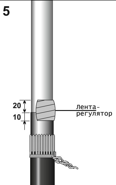
Выполнить подмотку одной лентой-регулятора длиной **0.2м** участка кабеля с заходом **10мм** на проводящий слой и **20мм** на изоляцию жилы. Подмотку производить вытягивая ленту до половины исходной ширины с **30%** перекрытием слоев, постепенно удаляя Упаковочную бумагу.
