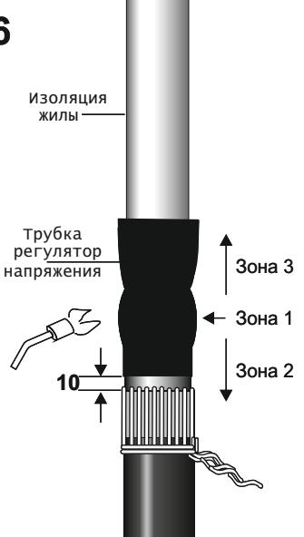
Надеть трубку регулятор напряжения (TPH-35) **200 мм** на разделку кабеля не доходя **10мм** до проволок экрана. Усадить трубку, начиная в области центра намотки ленты-регулятора - зона 1, затем продолжить в сторону основания разделки кабеля - зона 2 и завершить усадку на изоляции жилы - зона 3.
