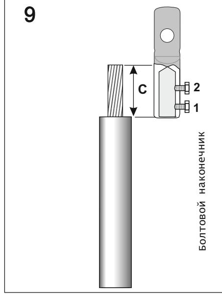
**Болтовой наконечник:** Удалить изоляцию с конца жилы кабеля на длине **C** равной глубине цилиндрической части наконечника. (Не допускать образование засечек и борозд на токоведущей части жилы)
