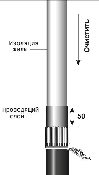
Тщательно удалить проводящий слой с поверхности изоляции жилы кабеля специальным инструментом, не доходя **50мм** до среза наружного покрова. Очистить изоляцию жилы при помощи салфетки.
