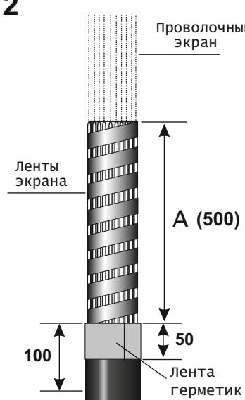
Удалить ленты проводящей бумаги и металлические ленты экрана до среза наружного покрова кабеля. Очистить и обезжирить **100мм** наружного покрова кабеля.
