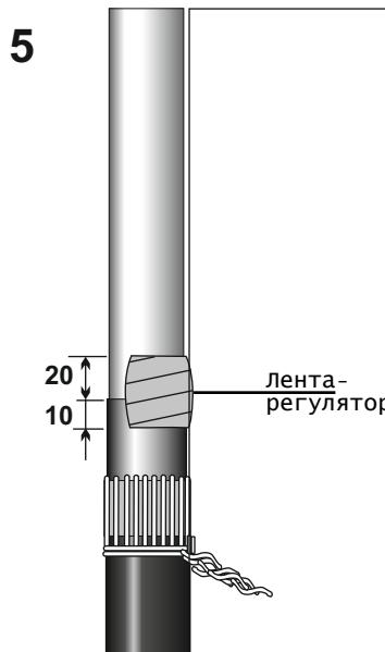
Выполнить подмотку одной лентой-регулятора длиной **100 м** участка кабеля с заходом **10мм** на проводящий слой и **20мм** на изоляцию жилы. Подмотку производить вытягивая ленту до половины исходной ширины с **30%** перекрытием слоев, постепенно удаляя упаковочную бумагу.
