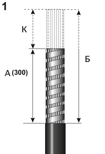
Удалить наружный покров кабеля на длине **A (300мм)**.
