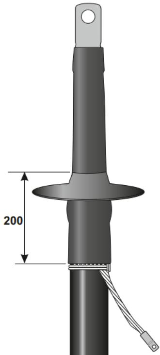
Для муфт наружной установки в целях увеличения длины пути тока утечки внешней изоляции (если это необходимо) установить термоусаживаемый изолятор ИП на трубку ТУТр. Первым необходимо устанавливать нижний изолятор, как показано на рисунке. Усадить изолятор ИП. Монтаж муфты наружной установки закончен.
