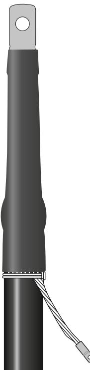
Установить наконечник заземления на экран кабеля. Закрепить наконечник заземления. Монтаж муфты внутренней установки окончен.
