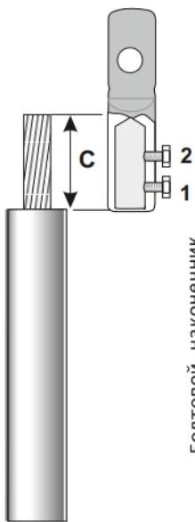
**Болтовой наконечник:** Удалить изоляцию с конца жилы кабеля на длине **C** равной глубине цилиндрической части наконечника. (Не допускать образования засечек и борозд на токоведущей части жилы).
