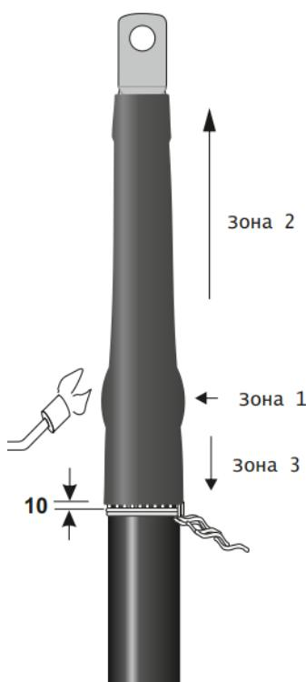
Надеть на разделанный конец кабеля трубку ТУТр (трекингстойкую) так, чтобы ее нижний край не доходил до проволочного бандажа 10 мм. Усадить трубку ТУТр сначала в зоне - 1, затем продолжить усадку в направлении наконечника - зона 2 и завершить усадку в сторону наружного покрова - в зоне 3.
