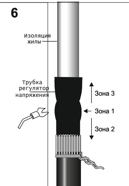
Надеть трубку регулятор напряжения (TPH) **150 мм** на разделку кабеля в плотную к проволокам экрана. Усадить трубку, начиная в области центра намотки ленты-регулятора - зона 1, затем продолжить в сторону основания разделки кабеля - зона 2 и завершить усадку на изоляции жилы - зона 3.
