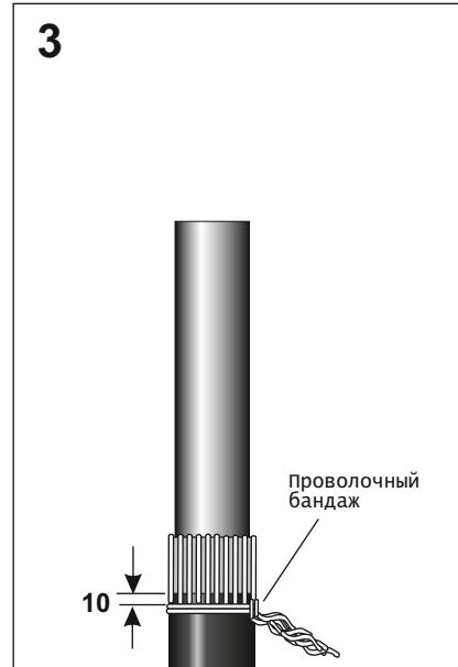
Отогнуть и равномерно разложить проволоки экрана на наружном покрове кабеля, избегая при этом перехлеста проволок. Закрепить проволоки экрана кабеля **3-4** витками медной проволоки в **10мм** от нижнего края ленты герметика на наружном покрове кабеля. Удалить ленты проводящей бумаги с проводящего слоя. Сплести проволоки экрана, образуя провод заземления.
