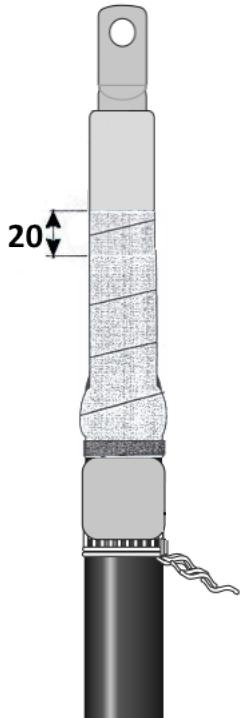
Произвести намотку бандажной ленты ЛЭСБ на разделанный конец кабеля, начав намотку от герметика со стороны проволок экрана, продолжить до герметика на наконечнике с заходом на него на **20 мм** и вернуться к герметику со стороны проволок экрана. Ленту наматывать с **50%** перекрытием слоёв с подтягивающим усилием. Ленту следует вымотать всю. Край ленты ЛЭСБ зафиксировать изолентой.
