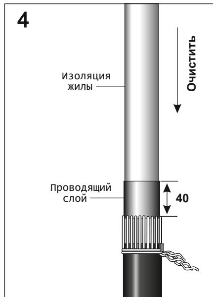
Тщательно удалить проводящий слой с поверхности изоляции жилы кабеля специальным инструментом, не доходя **40мм** до среза наружного покрова. Толщина изоляции после снятия проводящего слоя должна быть не менее 3,5 мм. Очистить изоляцию жилы при помощи салфетки.
