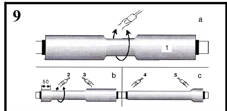
Отогнуть проволоки экрана с наружного покрова и брони кабеля на муфту. Сплести концы проволок вместе и соединить в области центра муфты с помощью болтового механического соединителя, входящего в комплект. Равномерно распределить проволоки экрана по муфте.
