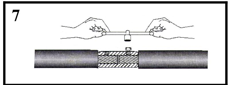
Очистить и обезжирить соединитель. Обмотать соединитель пластиной-регулятором. При обмотке пластину следует разместить по центру на соединителе так, чтобы край пластины закрывал места срыва контактных болтов. Обернуть соединитель постепенно удаляя упаковочную бумагу. Края пластины необходимо прижать к поверхности трубок. **Внимание!** Пластина накладывается без натяжения.
