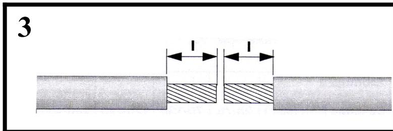
Достать короткие ленты-регуляторы желтого цвета. Наложить подмотку лентами, сняв упаковочную бумагу, с заходом на полупроводящий экран на 20мм и по изоляции на 10мм.
