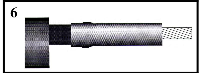
Установить на жилы соединитель так, чтобы между окончанием соединителя и изоляцией не было зазора. Подтянуть болты соединителя на обеих жилах, затем довернуть болты до срыва головок.
