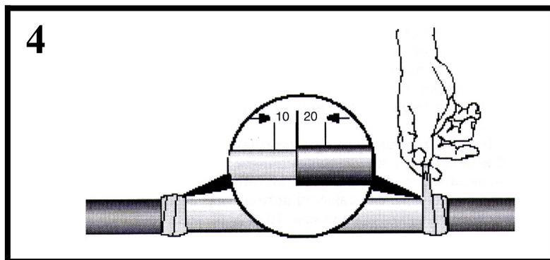
Надвинуть на жилы трубки регулятор напряжения ТРН (черного цвета), совместив край трубки со срезом изоляции. Усадить трубку, начиная от конца жилы по направлению к кабелю.
