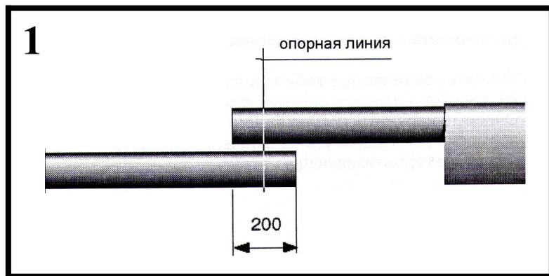
Удалить с кабелей наружный покров в соответствии с размерами **a** и **b** (см. Таблицу 1).
