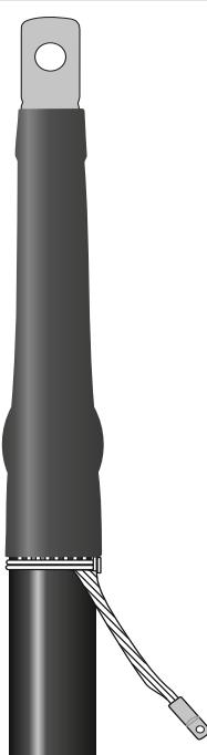
Установить наконечник заземления на экран кабеля. Закрепить наконечник заземления. Монтаж муфты внутренней установки окон-чен.
