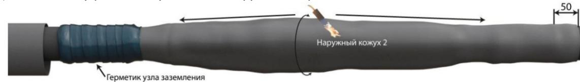
Надвиньте наружный кожух №1 с заходом 100мм на наружный кожух №2, усадите прогревая по кругу сначала в одну сторону, затем в другую.
