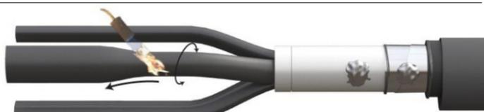
Короткую ленту маслостойкого герметика отделить от подложки и скрутить из него конус. Вставить конус между жилами и уплотнить до появления между жилами. Удалить пояску оболочки до второго надреза. Наложить бандаж из ниток на ленты полупроводящей бумаги на расстоянии 5мм от среза оболочки кабеля. Удалить ленты полупроводящей бумаги до бандажа. Удалить бандаж из ниток.
