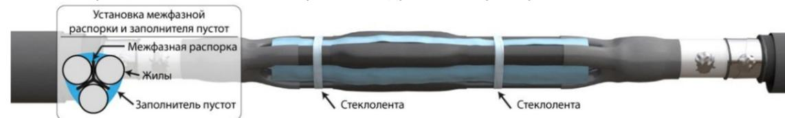
Обмотать стеклолентой место укладки межфазного заполнителя. Намотку следует начинать от основания пальцев перчатки, с подтягивающим усилием и 50% перекрытием. Концы намотки закрепить изолянтай.
