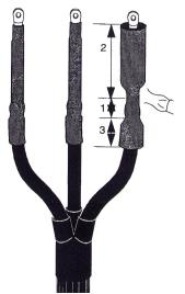
Предварительно прогреть наконечники. Надвинуть на жилы трубки ТУТтр (трекингостойкие) так, чтобы они закрывали трубчатую часть наконечника. Усадить трубку ТУТтр сначала в области среза полупроводящего слоя, используя мягкое пламя горелки желтого цвета. Затем продолжить усадку в направлении наконечника и в последнюю очередь усадить трубку на наружный покров. Последовательность усадки показана на рисунке цифрами.
