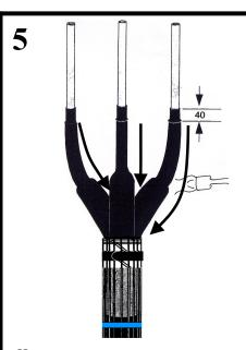
Надвинуть на каждую из жил проводящие трубки ТПР, установив их верхний край на расстоянии 40мм от среза полупроводящего слоя. Усадить трубки ТПР, начиная от концов жил в направлении корешка разделки. Дать трубкам остыть до продолжения монтажа.
