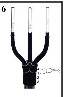
Надвинуть на разделку перчатку ТУПпп, установив ее по возможности глубже в корешок. Усадить перчатку ТУПпп в последовательности указанной на рисунке цифрами.
