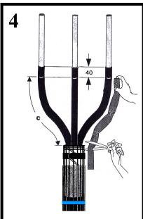
В 40 мм от среза полупроводящего слоя выполнить разметку и в соответствии с размером С (в зависимости от выбранной длины разделки) нарезать проводящие трубки ТПР.
