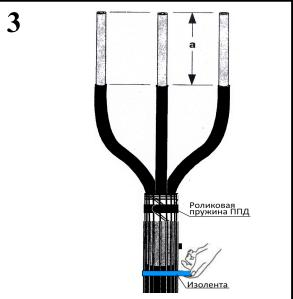
Удалить межфазные заполнители на разделанном участке кабеля. Изогнуть жилы, расположив их по месту присоединения. Обрезать жилы на необходимой длине. Тщательно удалить полупроводящий экран по размеру **a=250мм.** Поверхность изоляции должна быть свободна от любых следов полупроводящего материала. Сгладить все неровности в области среза полупроводящего экрана. Внимание! Не повредите при этом изоляцию.
