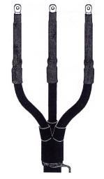
Концевая муфта внутренней установки смонтирована. Закрепить экранные проволоки на наружном покрове кабеля ниже манжеты при помощи проволочного бандажа. Скрутить экранные проволоки вместе для образования проводника заземления. Установить наконечник заземления на экран кабеля. Закрепить наконечник заземления. Монтаж муфты внутренней установки окончен.
