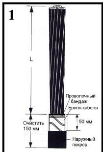
Отрезать кабель и удалить броню и наружный покров на длине, необходимой для подключения к оборудованию.
