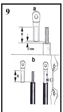
Удалить изоляцию в соответствии с размером  ${\bf K}$  (см. рисунок).
