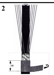
Обернуть ленту-герметик вокруг окончания наружного покрова на длине 80мм. Аккуратно отогнуть все проволоки экрана на броню и наружный покров, избегая перехлестывания проволок. Закрепить на броне проволоки экрана роликовой пружиной ППД. Временно закрепить проволоки экрана лентой ПВХ ниже герметизирующего слоя.
