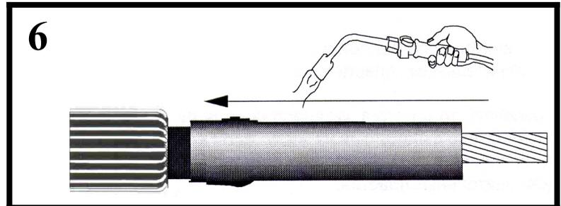
На жилы одного из кабелей надвинуть экранированную изоляционную трубку (черно-красную) - 1 и наружный кожух - 2.
