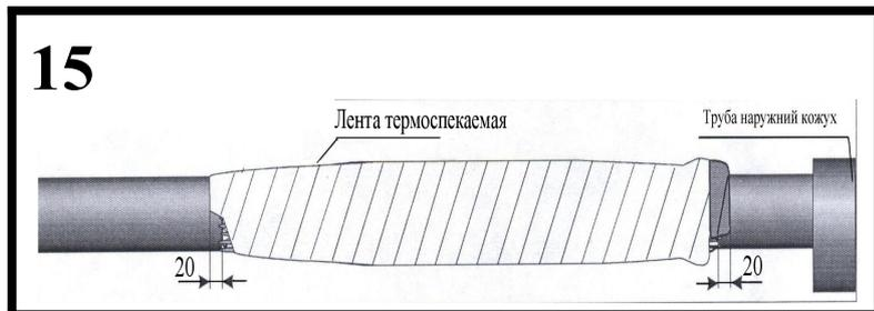
Очистить и обезжирить участки наружного покрова кабелей с обеих сторон от муфты на длине 200 мм. Надвинуть на муфту кожух ТТК, установив его по центру. Усадить кожух ТТК сначала в центре и продолжить в направлении наружных покровов соединённых кабелей. Смотрите рисунок 16.
