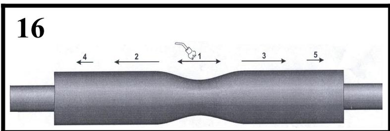
Соединительная муфта смонтирована. Следует дать муфте остыть, прежде чем подвергать её каким-либо механическим воздействиям.
