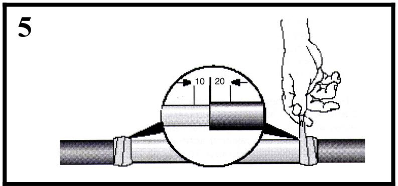
Надвинуть на жилы трубки регулятора напряжения ТРН (черного цвета), совместив край трубки со срезом изоляции. Усадить трубку, начиная от конца жилы по направлению к кабелю.
