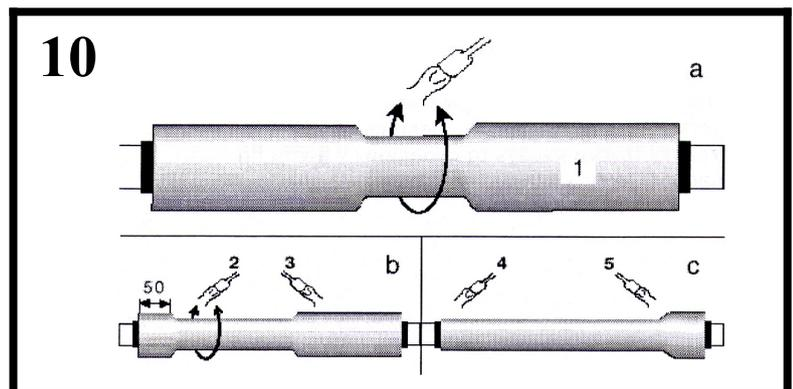
Выполнить обмотку лентами-регулятора (длиной 0,2 м) участков основания разделки кабелей, с заходом на изоляционную трубку, используя по одной ленте-регулятора на каждую сторону, до полного заполнения свободного пространства между проволочным экраном и изоляционной трубкой.
