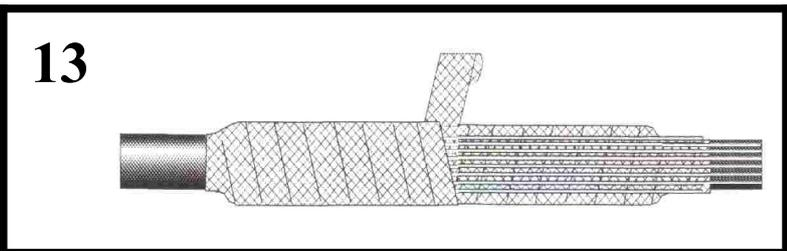
Закрепить проволоки экрана на наружном покрове кабеля изолентой в 50 мм от основания разделки кабеля. Лишнюю длину проволок экрана обрезать и обмотать острые края изолентой. Зафиксировать окончание подмотки медной сетки роликовой пружиной, наматывая её с подтягивающим усилием в месте ранее наложенной пружины по возможности ближе к двухслойной трубе.
