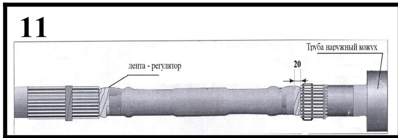
Обернуть муфту одним слоем медной сетки с 50% перекрытием, начав намотку с проволок экрана меньшей длины в соответствии с рисунком 12.
