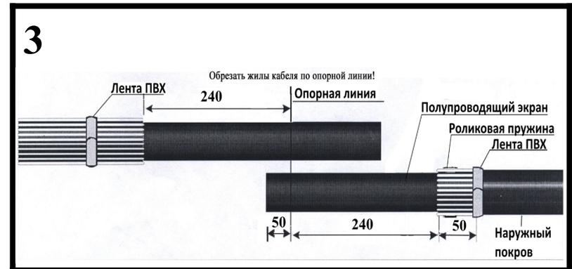
Удалить с концов жил обеих кабелей изоляцию на длине I (см. Таблицу 2). Тщательно удалить полупроводящий экран жил с изоляции не доходя 40 мм до среза наружного покрова так, чтобы на поверхности изоляции не оставалось никаких следов проводящего материала. Очистить и обезжирить изоляцию.
