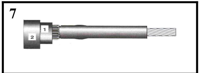
Установить на жилы соединитель так, чтобы между окончанием соединителя и изоляцией не было зазора.
