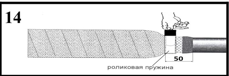
Пружину для усиления прижимных свойств повернуть рукой в сторону её вымотки и дополнительно заматывать изолентой.
