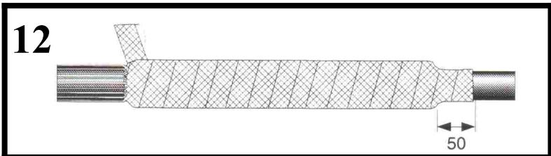
Снять временно наложенную изоленту, закрепляющую проволоки экрана большей длины. Отогнуть длинные проволоки экрана на муфту так, чтобы они заходили на проволоки экрана меньшей длины. Разложить проволоки параллельно друг другу, и покрыть их вторым слоем медной сетки с 50% перекрытием до начала первого слоя.
