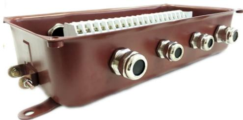
Коробки У614 и У615 комплектуются металлическими или пластмассовыми кабельными вводами. На наружной поверхности имеют ушки, предназначенные для их крепления к строительным конструкциям с помощью стандартных крепежных изделий или сварки.
