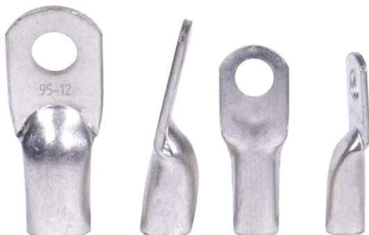
Наконечники кабельные медные луженые ТМЛо используются для оконцевания проводов и кабелей с медными жилами сечением от 6 до 95 мм<sup>2</sup> и применяются для кабелей напряжением до 10 кВ. Наконечники закрепляются на жилах опрессовкой.
