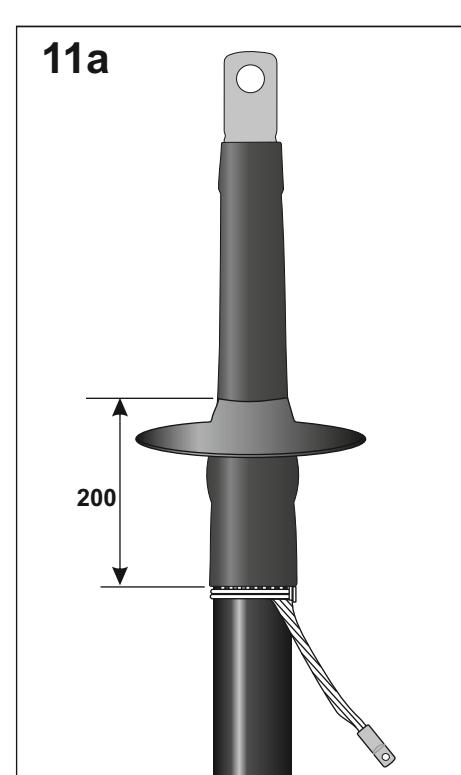
Для муфт наружной установки в целях увеличения длины пути тока утечки внешней изоляции (если это необходимо) установить термоусаживаемый изолятор ИП на трубку ТУТр. Первым необходимо устанавливать нижний изолятор, как показано на рисунке. Усадить изолятор ИП. Монтаж муфты наружной установки закончен.
