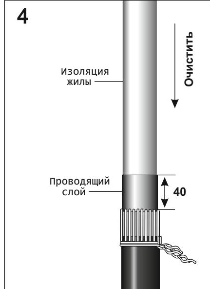
Тщательно удалить проводящий слой с поверхности изоляции жилы кабеля специальным инструментом, не доходя **40мм** до среза наружного покрова. Толщина изоляции после снятия проводящего слоя должна быть не менее 5 мм. Очистить изоляцию жилы при помощи салфетки.
