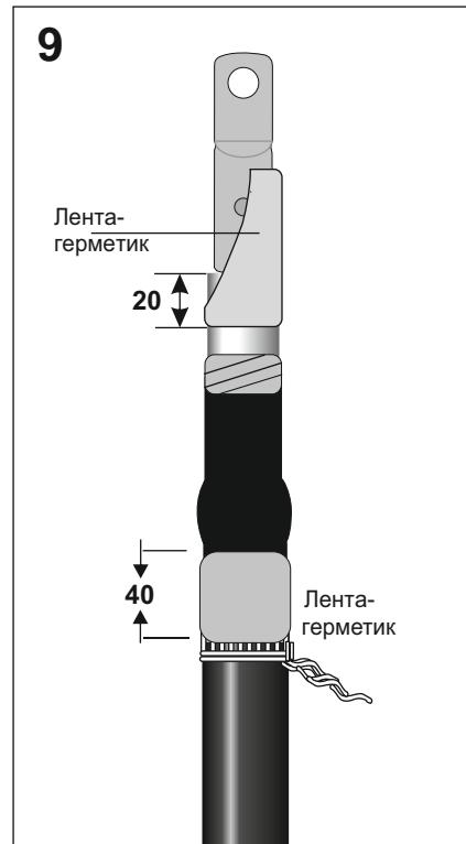
Выполнить подмотку лентой регулятором длиной **0,15м**, участок разделки кабеля с заходом **10мм** на трубку ТРН и **20мм** на изоляцию жилы кабеля. Подмотку производить вытягивая ленту до половины исходной ширины с **30%** перекрытием слоев, постепенно удаляя упаковочную бумагу
