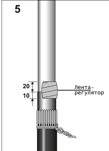
Выполнить подмотку одной лентой-регулятора длиной **150 м** участка кабеля с заходом **10мм** на проводящий слой и **20мм** на изоляцию жилы. Подмотку производить вытягивая ленту до половины исходной ширины с **30%** перекрытием слоев, постепенно удаляя упаковочную бумагу.
