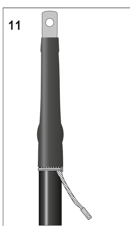
Надеть на разделанный конец кабеля трубку ТУТр (трекингостойкую) так, чтобы ее нижний край не доходил до проволочного бандажа 10 мм. Усадить трубку ТУТр сначала в зоне - 1, затем продолжить усадку в направлении наконечника - зона 2 и завершить усадку в сторону наружного покрова - в зоне 3.
