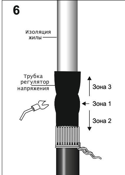
Надеть трубку регулятор напряжения (TPH) **200 мм** на разделку кабеля в плотную к проволокам экрана. Усадить трубку, начиная в области центра намотки ленты-регулятора - зона **1**, затем продолжить в сторону основания разделки кабеля - зона **2** и завершить усадку на изоляции жилы - зона **3**.
