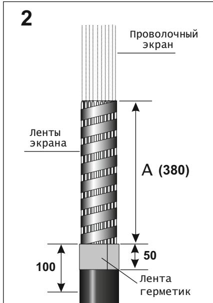
Удалить ленты проводящей бумаги и металлические ленты экрана до среза наружного покрова кабеля. Очистить и обезжирить **100мм** наружного покрова кабеля.
