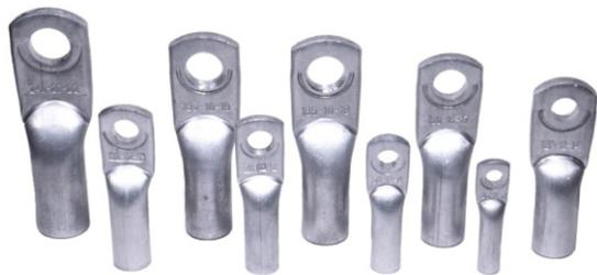
Наконечники кабельные алюминиевые ТА, закрепляемые опрессовкой, предназначены для оконцевания алюминиевых жил кабелей и проводов сечением от 16 до 240 мм<sup>2</sup> на напряжение до 35 кВ. Наконечник одевается на жилу кабеля и опрессовывается гидравлическим или ручным прессом. Такой метод жёстко скрепляет наконечник и жилу кабеля, обеспечивая надёжный контакт.
