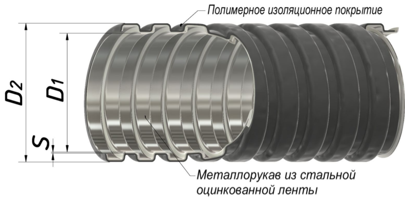
Рисунок 1. Металлорукав типа МРПИ нг черный с протяжкой
