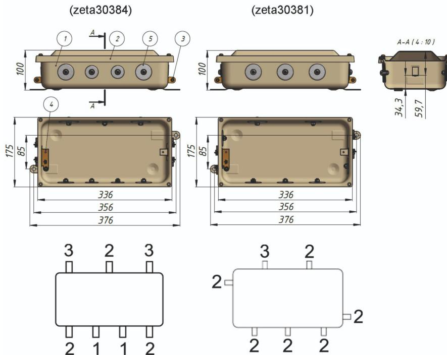
1 - отверстие Ø20 мм
