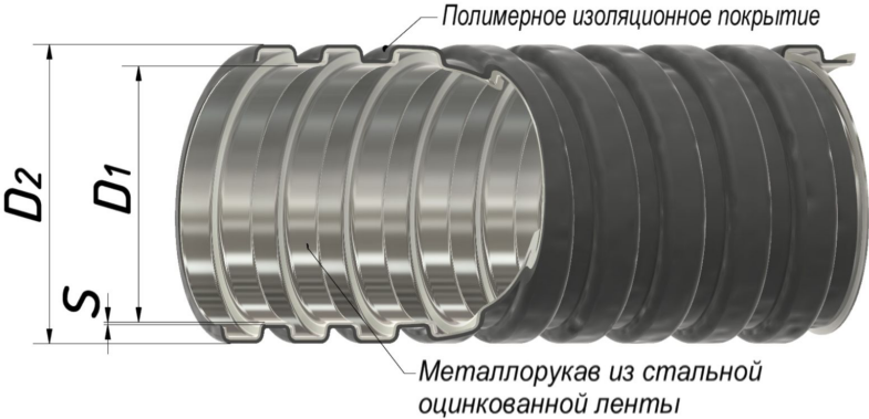
Рисунок 1. Металлорукав типа МРПИ нг морозостойкий
