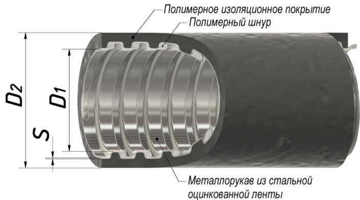
Рисунок 1. Металлорукав типа МПП нг черный
