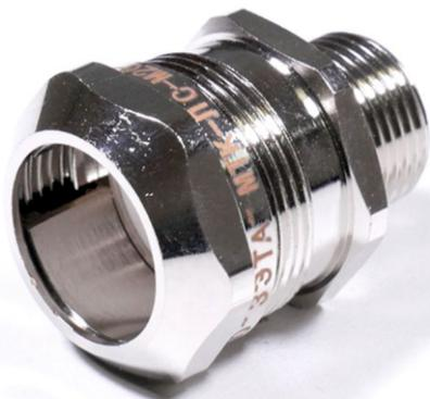
Муфты МТК (с наружной присоединительной резьбой) являются трубной арматурой для герметичного и надежного присоединения к электрооборудованию жесткой безрезьбовой металлической трубной системы прокладки кабелей по ГОСТ Р МЭК 61386.1-2014 (то есть для присоединения к электрооборудованию безрезьбовой металлической трубы по ГОСТ 3262-75 для целей прокладки кабелей)
