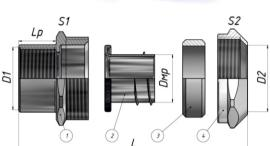
Муфты МВВ [с внутренней присоединительной резьбой] является трубной арматурой для герметичного и надежного соединения частей гибкой гофрированной металлической или композитной трубной системы и жесткой резьбовой металлической трубной системы прокладки кабелей по ГОСТ Р МЭК 61386.1-2014 (то есть для соединения металлорукава типов МРПИ, МПГ, ШЭМ, РЗ-Ц, РЗ-ЦХ, РЗ-ЦА, РЗ-ЦП или других с резьбовой металлической трубой по ГОСТ 3262- 75 или фитингом с наружной резьбой для целей прокладки кабелей).
